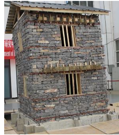
२ तले ढुंगाको घरको वास्तविक मोडेलमा प्रबलीकरण नगरिएको घरमा ठाण्डो क्षति तथा काठको ब्याण्ड राखिएको र जि.आई. तारको जालीको प्रबलीकरण प्रयोग गरी निर्माण गरिएको घर । ©एनसेट
