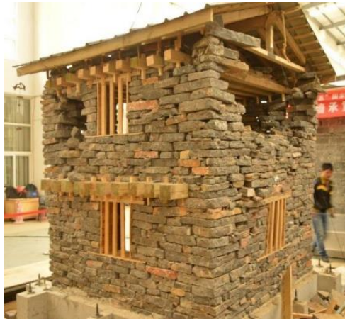
२ तले ढुंगाको घरको वास्तविक मोडेलमा प्रबलीकरण नगरिएको घरमा ठाण्डो क्षति तथा काठको ब्याण्ड राखिएको र जि.आई. तारको जालीको प्रबलीकरण प्रयोग गरी निर्माण गरिएको घर । ©एनसेट
